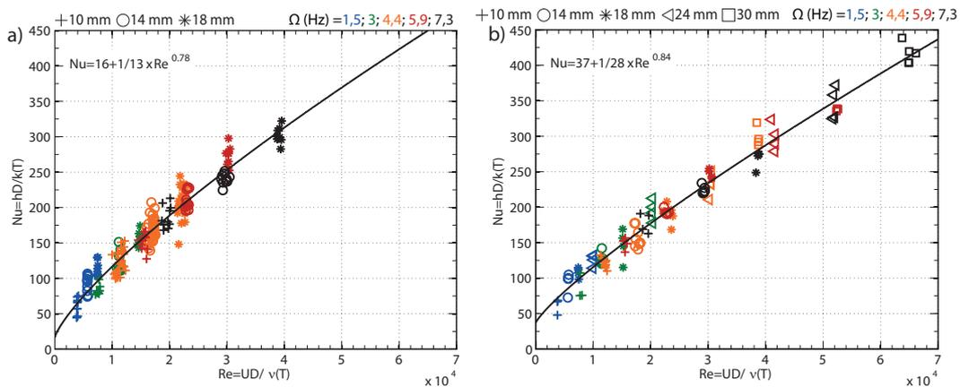
FIGURE 5 – Évolution, à l’échelle des billes de glace, du nombre de Nusselt en fonction du nombre de Reynolds pour le cas des glaçons fixes dans l’écoulement à deux disques (a) ou à un disque (b).
