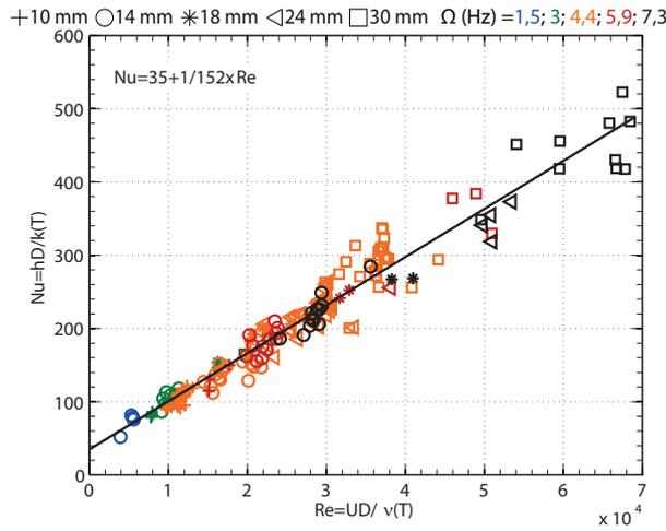
FIGURE 4 – Évolution, à l’échelle des billes de glace, du nombre de Nusselt en fonction du nombre de Reynolds pour le cas des glaçons libres dans l’écoulement à deux disques.
