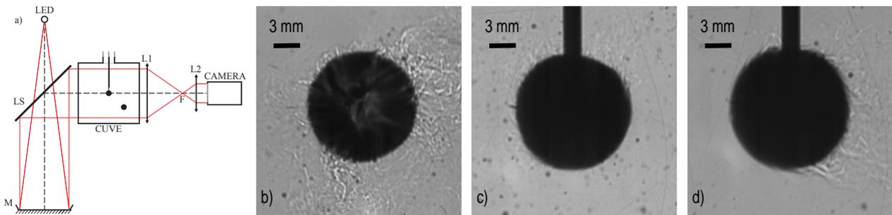
FIGURE 2 – Images de billes de glace obtenues avec le montage d'ombroscopie afocal (a) : la frontière entre les deux phases est nette, et nous observons également les panaches thermiques émanant de la fusion des billes. b) : glaçon libre. c) : glaçon fixe dans l'écoulement à deux disques. d) : glaçon fixe dans l'écoulement à un disque.
