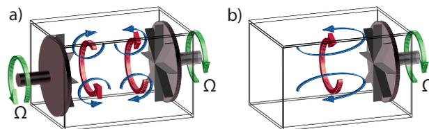
FIGURE 1 – Schéma de l'écoulement moyen dans un écoulement de von Kármán à section carrée. a) : deux disques contra-rotatifs produisent deux cellules contra-rotatives (flèches rouges) et deux recirculations méridiennes (flèches bleues). b) : un disque produit une forte rotation (flèche rouge) et une boucle de recirculation méridienne (flèches bleues).
